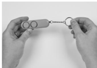
**GEBRAUCHSANWEISUNG:** Entfernen Sie den Plastikschutz der Batterie von der Rückseite des Gehäuses. Um den Alarm zu aktivieren, ziehen Sie den Stift aus dem Kunststoffgehäuse. Eine 120-dB-Sirene ertönt. Schieben Sie zum Deaktivieren den Stift zurück das Gehäuse, bis er einrastet. Es wird empfohlen, den persönlichen Alarm regelmäßig zu testen, um die Funktionsbereitschaft sicherzustellen. Ersetzen Sie die Batterien, wenn der persönliche Alarm nicht mehr ertönt oder die Lautstärke verringert ist.
